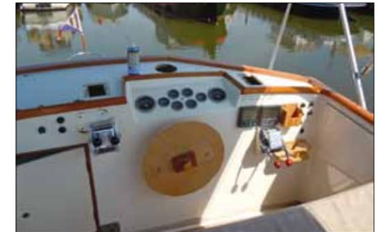
Sur le fly, barre à roue, pare-brise, inverseur et manette des gaz sont démontés pour perdre quelques centimètres et ramener le tirant d'air d'Argo à 3,50 mètres.
